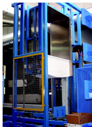
Der Paketabstapler koordiniert die Verpackungsinhalte für den Straffpacker.
