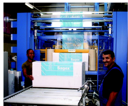
Die Folienverpackung mit der Straffpack-Maschine ist nun der letzte Arbeitsgang, bevor die Sagex -Pakete über eine 100 m lange Transportrollbahn in die Lagerhallen gelangen.
