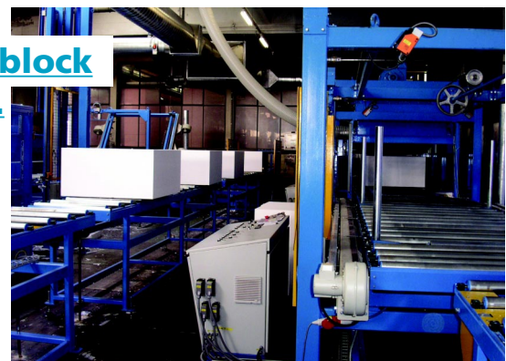
Der Sagex -Rohblock (rechts im Bild), wird nun in vier Einzelblöcke geschnitten und rundum besäumt.
